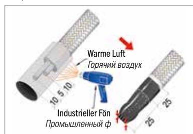
Eines der beiden Kabel kürzen. Die Thermoschrumpfung TRDP9-C wie angegeben platzieren und mit dem Fön schließen. Auf den Endbereich drücken und versiegeln.
