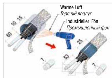
Die zweite Thermoschrumpfung TRDP9-A wie angegeben platzieren und mit dem Fön schließen. Bis 7mm die Isolierung der Kabel abziehen.
