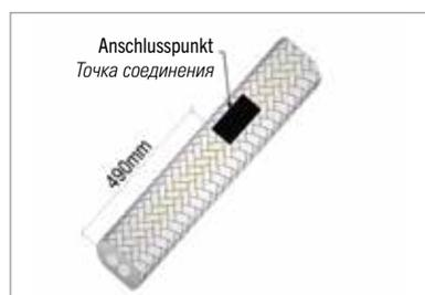
Das Heizkabel 490mm ab dem Anschlusspunkt durchschneiden (schwarzes Kennzeichen auf der Kabeloberfläche).
