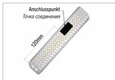
Das Heizkabel 120mm ab dem Anschlusspunkt durchschneiden (schwarzes Kennzeichen auf der Kabeloberfläche)
