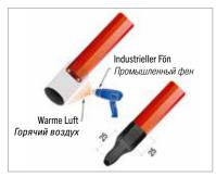
Nachdem das Heizkabel auf die angeforderte Länge geschnitten wurde, die Kappe ECPC am Endbereich aufstecken und mit dem Fön schließen.
