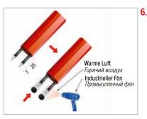
Die beiden Leiter mit den speziellen Thermoschrumpfungen TRPO32-A isolieren und mit dem Fön schließen.
