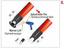
Die zweite Thermoschrumpfung TRDP9-C wie angegeben platzieren und mit dem Fön schließen. Eine Länge von 7mm des Leiters für die Verbindungen zur Verfügung stehen lassen.
