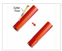
Die erste Isolierung durchschneiden und 32mm entfernen.
