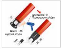
Die erste Thermoschrumpfung TRDP9-C ie angegeben platzieren und mit dem Fön schließen. Eine Länge von 7mm des Leiters für die Verbindungen zur Verfügung stehen lassen.
