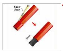
Die zweite Isolierung durchschneiden und 32mm entfernen.
