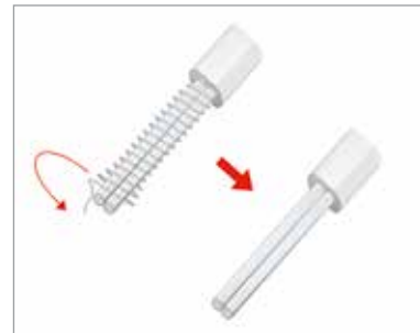
8. Tagliare e rimuovere il filo resistivo sino al bordo dell'isolante. Non danneggiare l'isolamento dei cavetti. Cut and remove the heating wire up to the insulating layer edge. Do not damage bus wires insulation.
