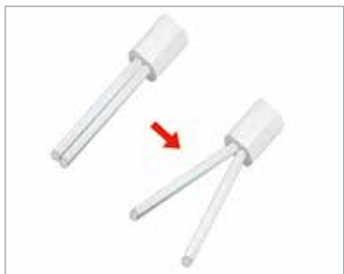
9. Dividere i due cavetti separando l'isolamento nella parte centrale. Divide bus wires cutting insulation jacket in the middle.
