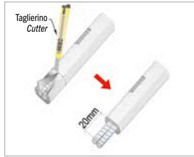
2. Tagliare e rimuovere l'isolamento per 20mm. Score and remove 20mm of insulation jacket.
