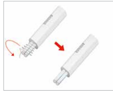
3. Tagliare e rimuovere il filo resistivo sino al bordo dell'isolante. Non danneggiare l'isolamento dei cavetti. Cut and remove the heating wire up to the insulating layer edge. Do not damage bus wires insulation.
