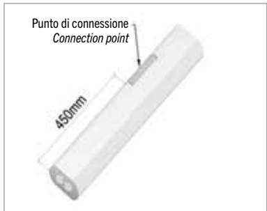
6. Tagliare il cavo riscaldante a 450mm massimo dal punto di connessione. Cut the heating cable at 450mm maximum from the connection point.
