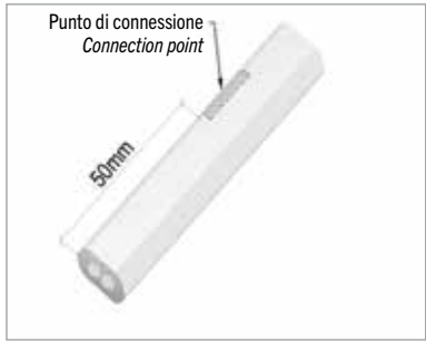
1. Tagliare il cavo riscaldante a 50mm dal punto di connessione. Cut the heating cable at 50mm from the connection point.
