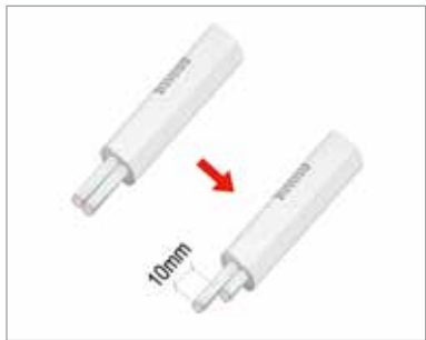
4. Accorciare uno dei due cavetti. Shorten one of the bus wires.
