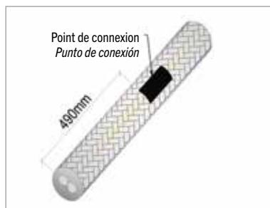
Couper le câble chauffant à 490mm du point de connexion (marque noire sur la surface du câble).
