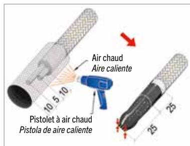
Raccourcir un des deux câbles. Positionner la gaine thermorétractable TRDP6-B comme indiqué et rétreindre avec le pistolet à air chaud. Appuyer et sceller l'extrémité.
