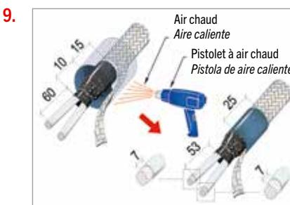
Positionner la deuxième gaine thermorétractable TRDP6-A comme indiqué et rétreindre avec le pistolet à air chaud. Dénuder l'isolation des câbles de 7mm.
