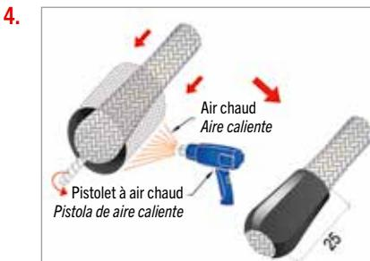
Abaissé la tresse métallique sur la gaine thermorétractable TRDP6-B, tourner et plier la tresse de cuivre. Rétreindre la gaine thermorétractable TRDP6-A comme indiqué.
