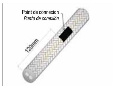
Couper le câble chauffant à 120mm du point de connexion (marque noire sur la surface du câble).
