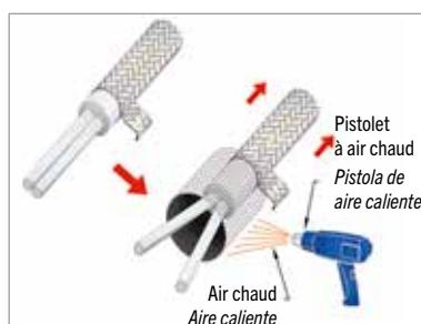
S'assurer que l'isolation des câbles ne soit pas endommagée. Positionner la gaine thermorétractable TRDP6-A comme indiqué et rétreindre avec le pistolet à air chaud.
