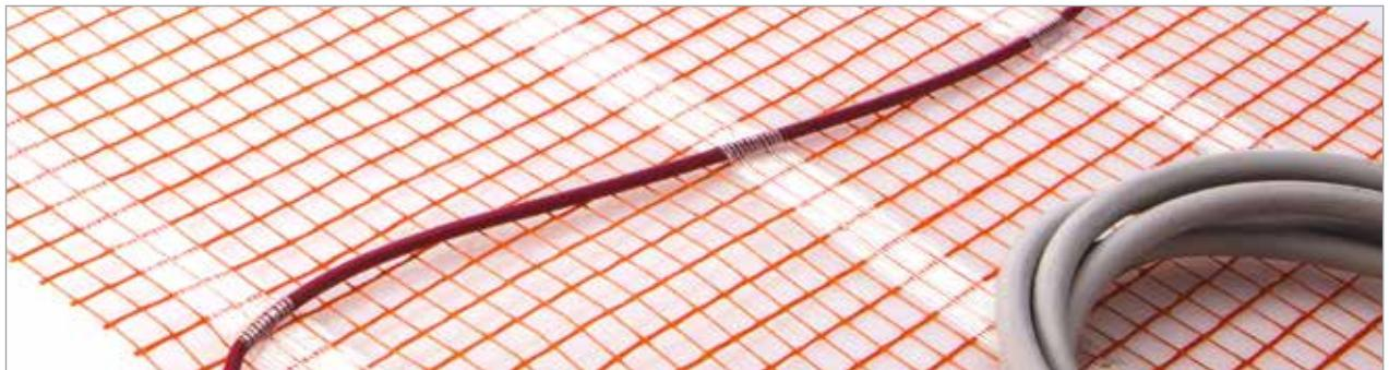
Le câble chauffant sur treillis SSRx est composé d'un câble chauffant pré-assemblé avec un ruban adhésif sur un treillis en fibre de verre. Spécifiquement conçu pour être placé à l'intérieur de la chape ciment, il est utilisé pour empêcher la formation de glace dans les chambres froides et pour éliminer la neige et la glace des rampes, des escaliers et des trottoirs. Installé dans les revêtements de sol domestiques, commerciaux et industriels, il permet le chauffage de ceux-ci.
