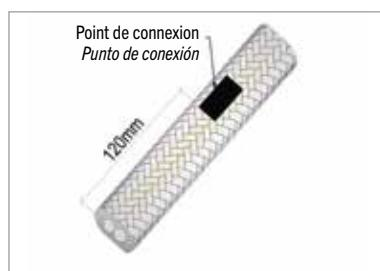
Couper le câble chauffant à 120mm du point de connexion (marque noire sur la surface du câble).
