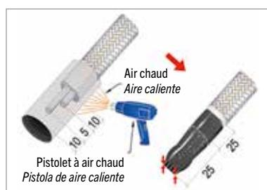
Raccourcir un des deux câbles. Positionner la gaine thermorétractable TRDP9-C comme indiqué et rétreindre avec le pistolet à air chaud. Appuyer et sceller l'extrémité.
