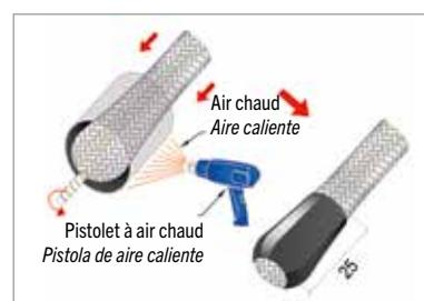
Abaissé la tresse métallique sur la gaine thermorétractable TRDP9-C, tourner et plier la tresse de cuivre. Rétreindre la gaine thermorétractable TRDP9-A comme indiqué.
