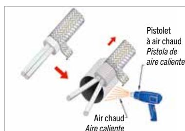
S'assurer que l'isolation des câbles ne soit pas endommagée. Positionner la gaine thermorétractable TRDP9-A comme indiqué et rétreindre avec le pistolet à air chaud.
