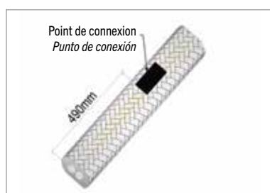
Couper le câble chauffant à 490mm du point de connexion (marque noire sur la surface du câble).
