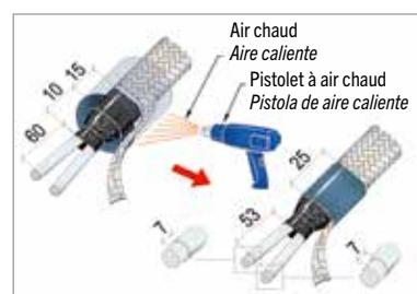
Positionner la deuxième gaine thermorétractable TRDP9-A comme indiqué et rétreindre avec le pistolet à air chaud.
