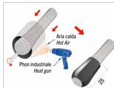
Abbassare la calza metallica sopra il termorestringente TRDP6-B, attorcigliare e piegare la treccia rame.
