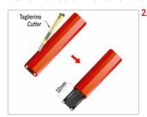
Tagliare e rimuovere l'isolamento per 32mm. Score and remove 32mm of insulation jacket.
