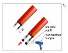
Isolare i due conduttori con gli appositi termorestringenti TRP032-A provvedendo alla chiusura con il phon. Seal the two bus wires with the respective TRP032-A heat-shrink sheaths and shrink with heat gun.
