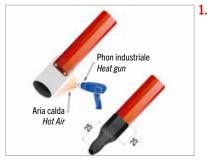
Dopo aver tagliato il cavo riscaldante alla lunghezza richiesta infilare il cappuccio ECPC sull'estremità e provvedere alla chiusura con il phon.
