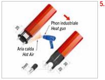
Posizionare il termorestringente TRDP9-C come indicato e chiudere con il phon. Lasciare a disposizione circa 7mm di conduttore per i collegamenti.
